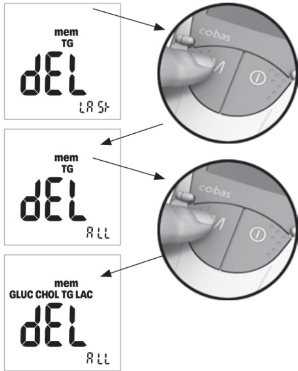
**10** Ako želite izbrisati **sve izmjerene vrijednosti za sve parametre ispitivanja**, dvaput pritisnite tipku **M**. Na zaslonu će se prikazati **dEL - ALL** i svi parametri ispitivanja.
