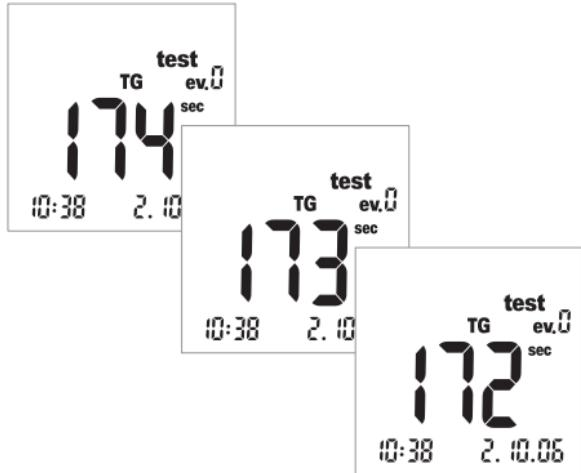
Mjerenje započinje. Vrijeme potrebno za vrednovanje uzorka ovisi o parametru ispitivanja. To vrijeme prikazano je na zaslonu i odbrojava se prema »0«. Vrijeme mjerenja pojedinih parametara ispitivanja jest:
