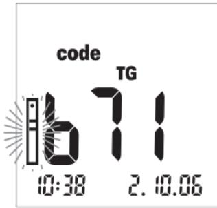
Na zaslonu se prikazuje troznamenkasti broj koda (koji je otisnut i na poleđini kodne trake i na spremniku traka za ispitivanje).
