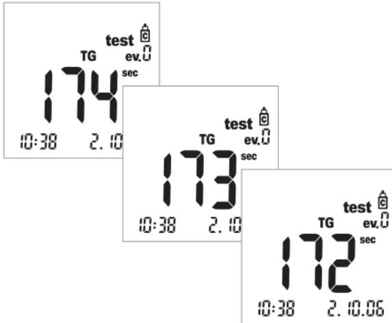
Mjerenje započinje. Vrijeme potrebno za vrednovanje uzorka ovisi o parametru ispitivanja. To vrijeme prikazano je na zaslonu i odbrojava se prema »0«. Vrijeme mjerena pojedinih parametara ispitivanja jest:
